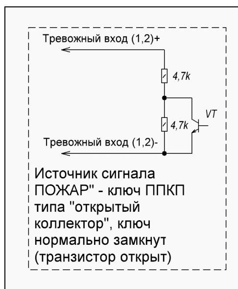
Рисунок 2.11 – Вариант подключения цепей запуска от ППКП
