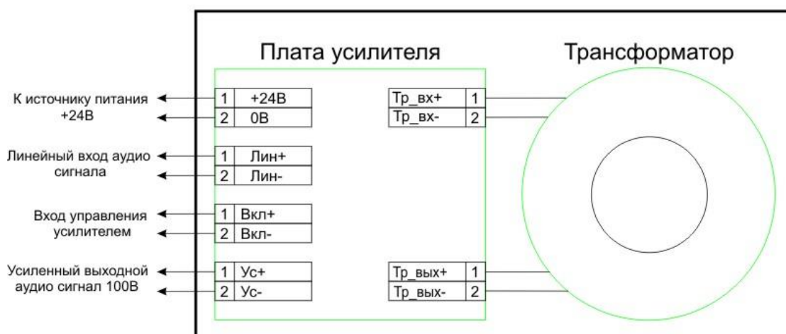
Рисунок 2.22 – Обозначение выводов УМ-150
