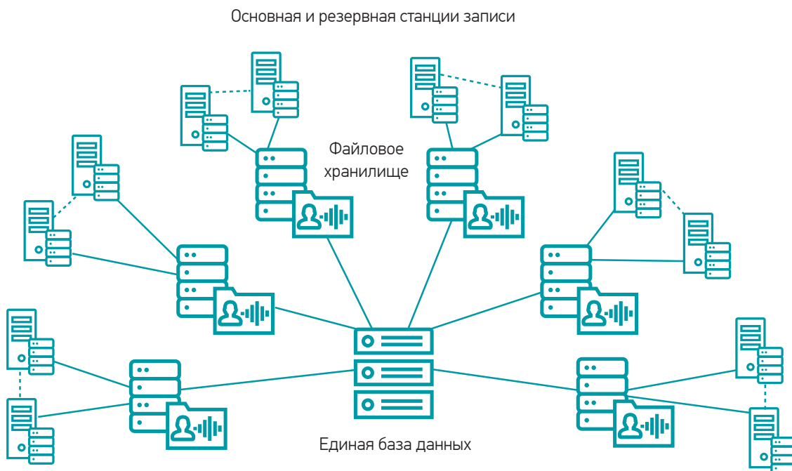
Типовая схема распределённого комплекса системы «Незабудка II»
