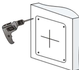
**2** Просверлите отверстия глубиной 30 мм. в местах наклейки-шаблона.
