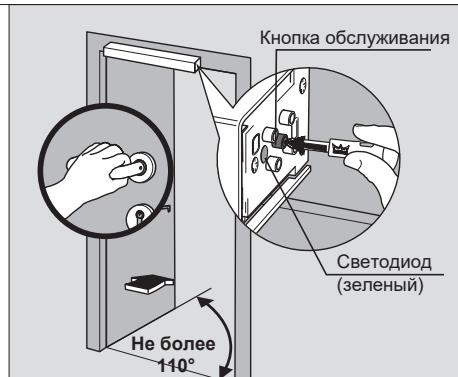
Через 10 секунд дверь закрывается на небольшой скорости. Начинается автоматический цикл.
