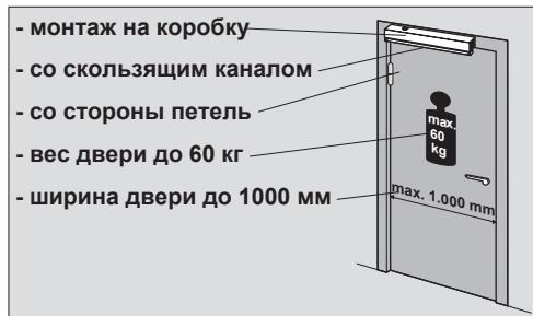
► Большинство внутренних дверей имеют ширину полотна менее 1000 мм, а вес полотна составляет менее 60 кг. Поскольку конструктивные особенности и базовые значения привода (монтаж со скользящим каналом, со стороны петель) соответствуют вышеупомянутым базовым значениям, привод двери может быть введен в эксплуатацию с помощью процедуры стандартного ввода в эксплуатацию.
