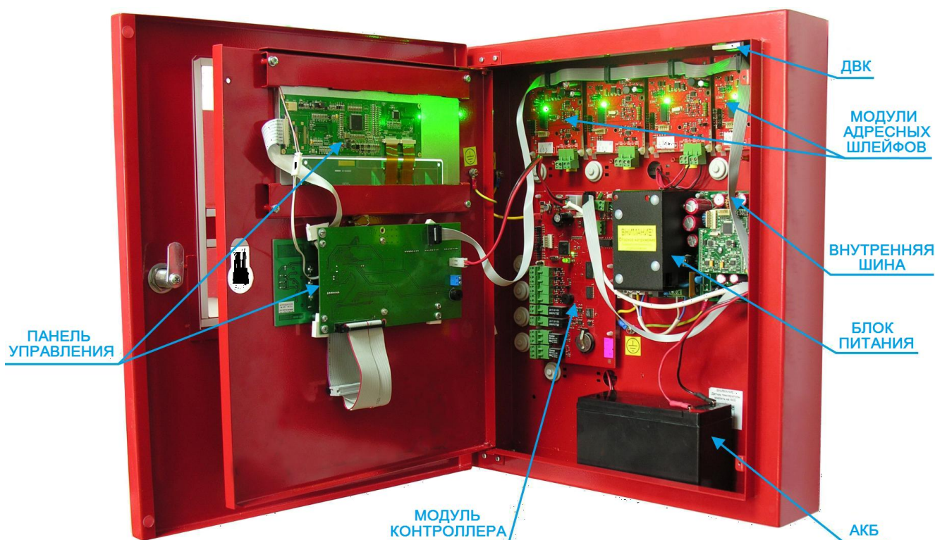
Рисунок 2. Внешний вид ППКиУ с открытой монтажной панелью.
