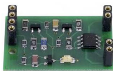
Рисунок 62 – Изолатор короткого замыкания 788612
