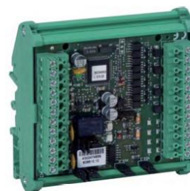
Рисунок 65 – корпус 788603.10 в сборе с установленным транспондером
