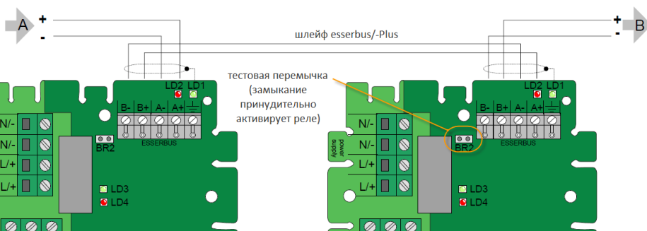
Рисунок 86 – подключение модуля 808621 к адресному шлейфу
