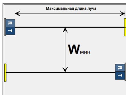
Рисунок 109 – Встречная установка извещателей
