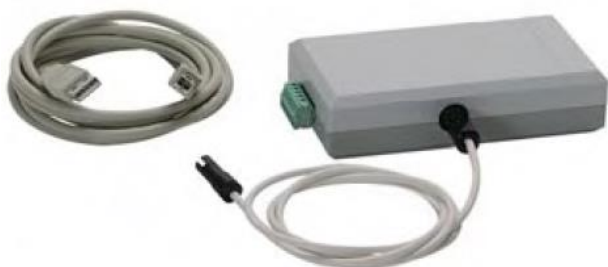
Рисунок 131 – интерфейс-программатор 789862.10 и кабели подключения
