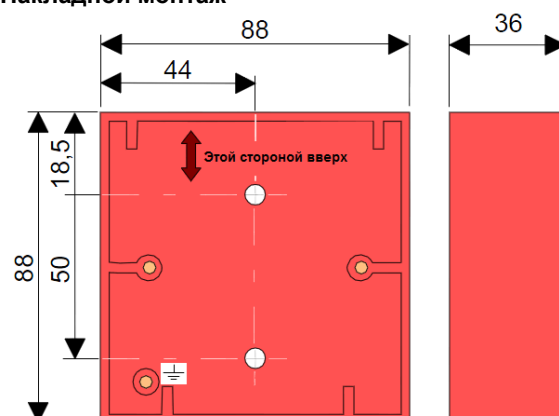
Рисунок 49 – База накладного монтажа ИПР в малом корпусе
