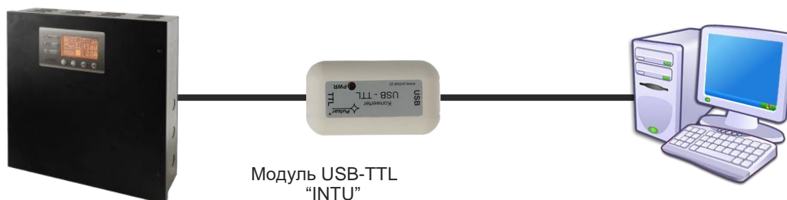
Связь по USB-TTL при помощи модуля USB-TTL „INTU”.
