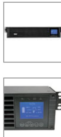
Высокопроизводительный онлайн-ИБП с двойным преобразованием и интерактивным ЖК-дисплеем идеально подходит для обеспечения работоспособности любого критически важного ИТ-оборудования голосовой связи, передачи данных, а также медицинского и промышленного назначения. Преобразует входной переменный ток в постоянный, а затем постоянный ток – в полностью стабилизированное питание переменного тока синусоидальной формы.
