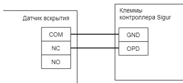
Подключение датчика вскрытия корпуса к контроллеру.
