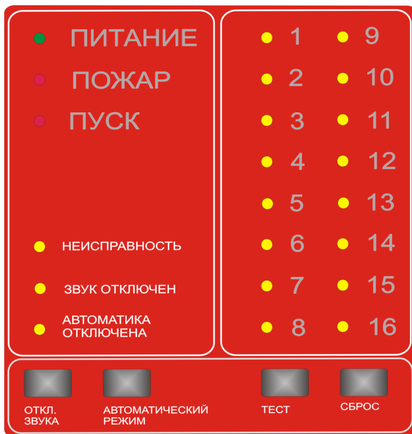
Рисунок 3.1. Органы управления и индикации ППКУ.
