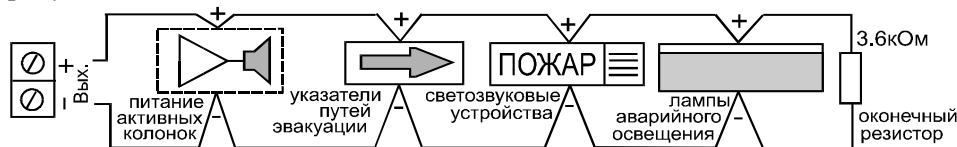
Рисунок 2 - Схема подключения нагрузок к выходам управления
