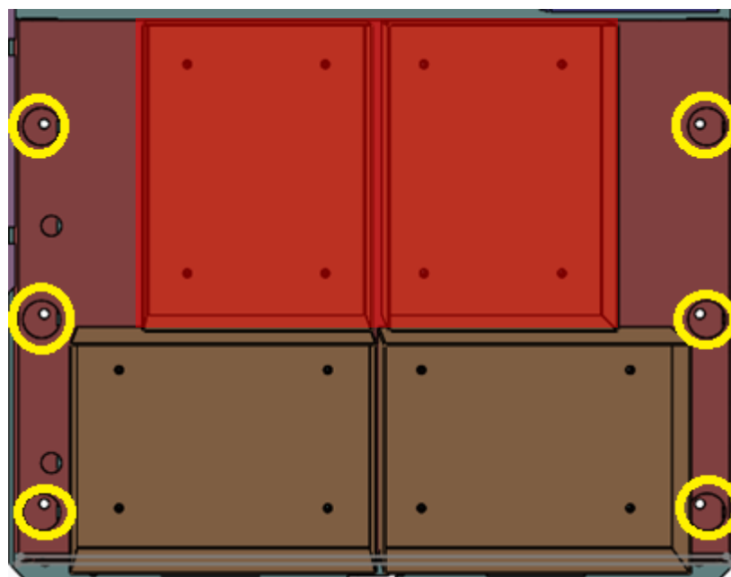
Рисунок 8.8 – расположение крепёжных отверстий на панели термостатов АКБ
