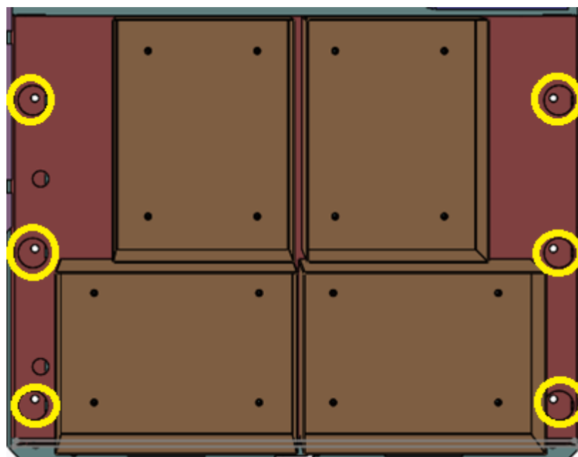
Рисунок 8.8 – расположение крепёжных отверстий на панели термостатов АКБ
