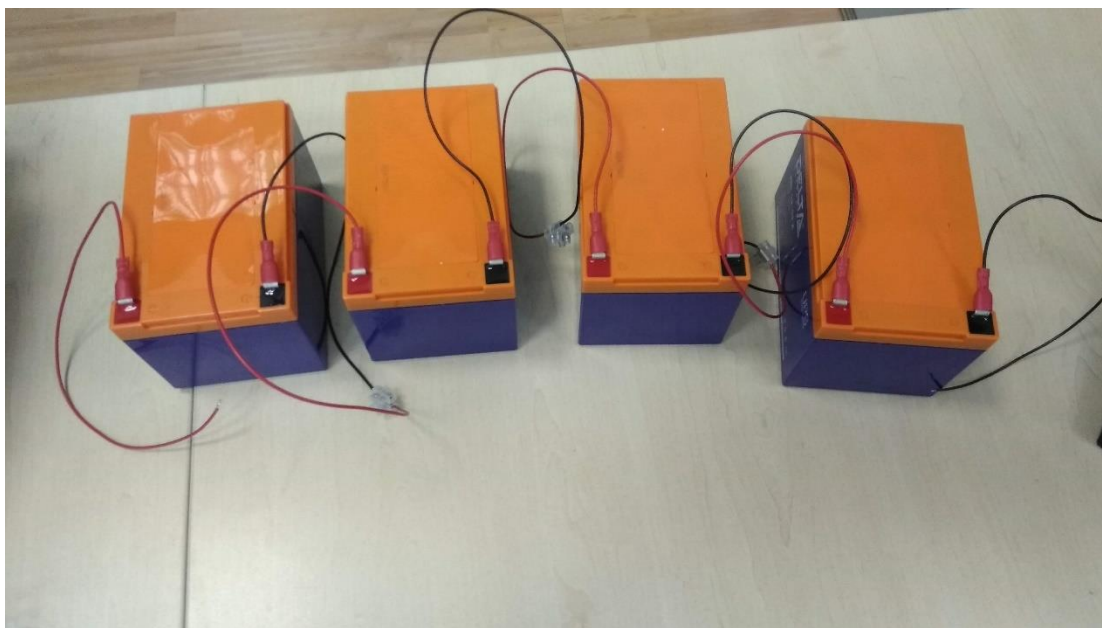
Рисунок 9.1 – подключение аккумуляторных батарей
