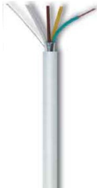
**КСПВ** - кабель с однопроволочными медными жилами диаметром 0,40, 0,50, 0,64, 0,80 мм, с изоляцией из композиции полиэтилена, с оболочкой из белого ПВХ пластика, предназначен для внутренней стационарной прокладки.
