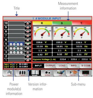
Fig. 54. Informationmenuofthemoduleorpowermodules.Main sub-menu.
