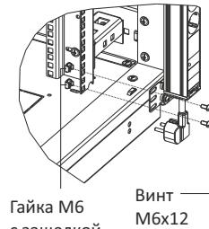
Установка с помощью дополнительного кронштейна СБ
