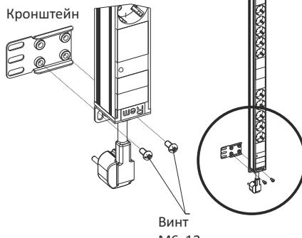
Установка вертикальных блоков в ШТК-М
