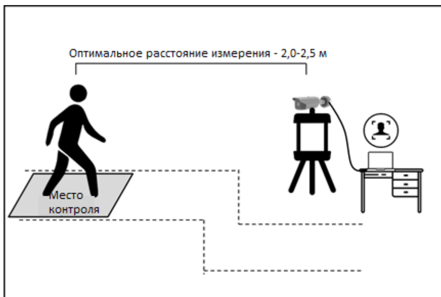
Рисунок 4-1 Рекомендуемое расстояние измерения температуры
