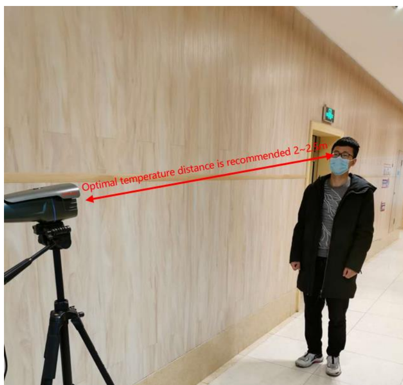
Рисунок 4-2 Реальная картинка с рекомендуемым расстоянием измерения температуры
