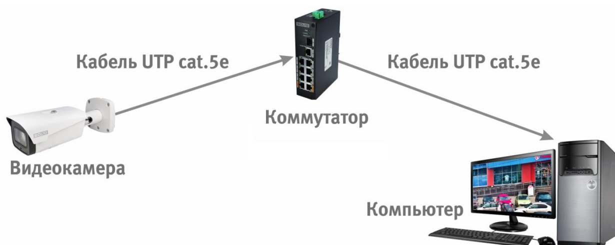
Рисунок 6.4 — Схема подключения видеокamеры к компьютеру через коммутатор
