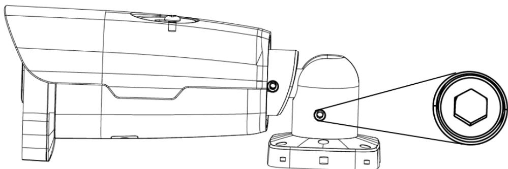
2) Установите пластину адаптера питания: снимите монтажную пластину и поверните пластину адаптера, чтобы подсоединить её к монтажной пластине.
