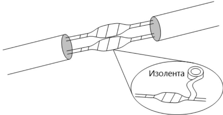
1) Плотно оберните соединения и концы кабеля изолентой:
