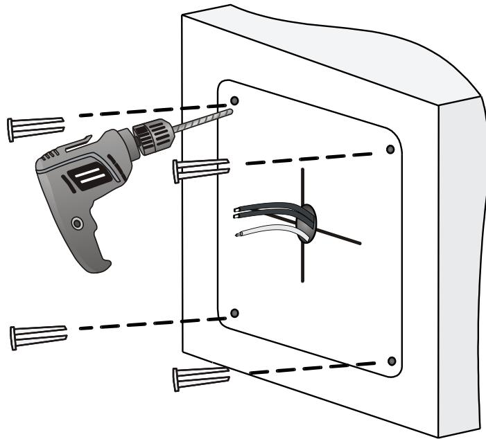
**ПРИМЕЧАНИЕ:** В данном примере хвостовые кабели пропущены сквозь стену. Но их также можно пропускать вбок и вдоль стены через специальные кабельные выходы в основании камеры.
