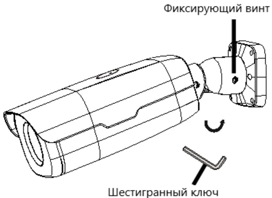
3. Установите камеру на стену: подсоедините все кабели, проденьте саморезы через отверстия в основании и закрепите их на стене с помощью отвертки:
