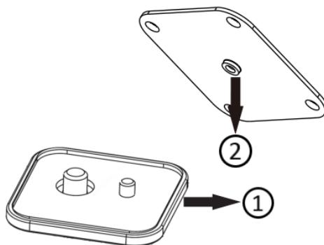
3) Завершение монтажа. Проложите хвостовые кабели и проведите их через отверстие для кабеля на основании камеры, вставьте винты в отверстия на основании и прикрепите их к переходной пластине с помощью отвертки, затем установите камеру на крепление для штатива:
