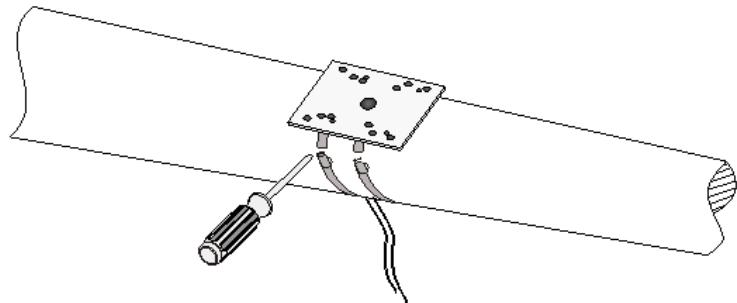
3) Закрепите устройство и универсальный шарнир на монтажной петле, отрегулируйте направление наблюдения и подключите все кабели:
