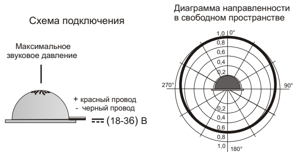
Рис.2 Схема подключения и диаграмма направленности оповещателя.
