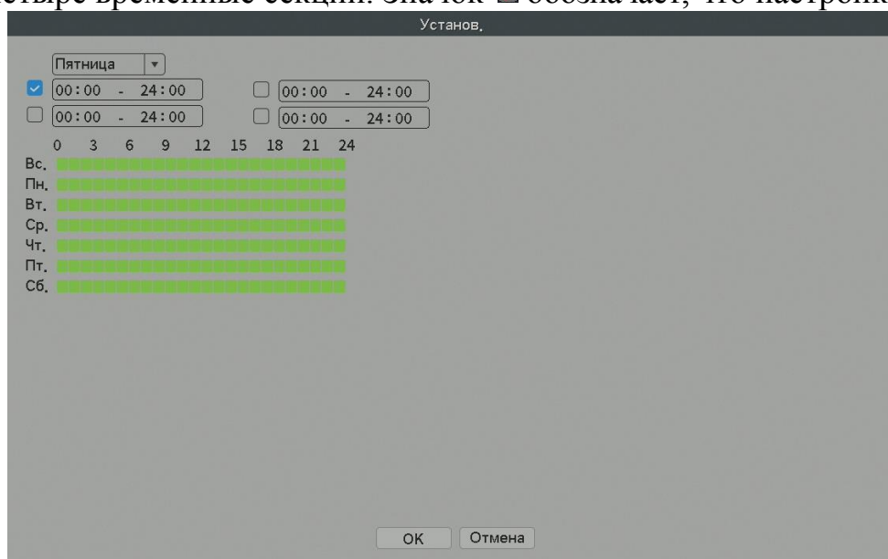
Рис.4.2 Установка времени обнаружения движения
