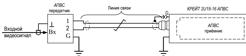
Рис.4 Схема включения АПВС-11К с заземлением и передатчика и КРЕЙТ 2U19-16 АПВС.
