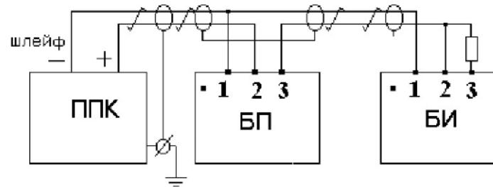
**СХЕМА ПОДКЛЮЧЕНИЯ ИЗВЕЩАТЕЛЯ К ППК
