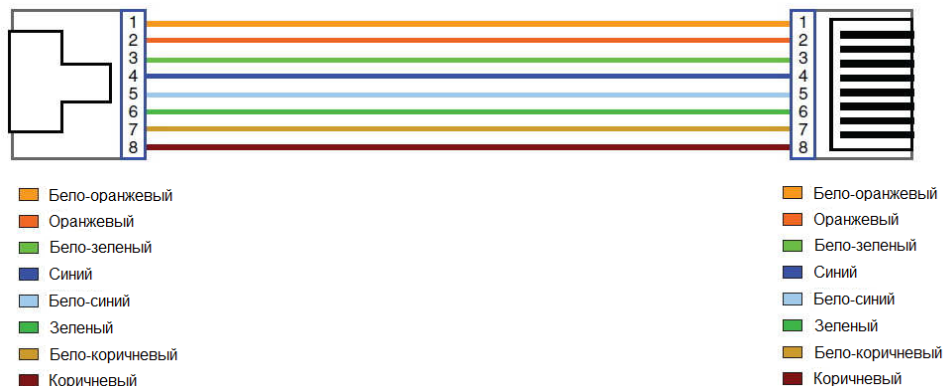
Рис. 10 Разводка кабеля по типу TIA/EIA-568-A.
