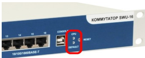
Рис.А.2. Индикаторы DEFAULT и CPU – коммутаторы SWU
