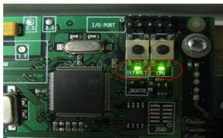
Рис.А.1. Индикаторы DEFAULT и CPU – коммутаторы PSW
