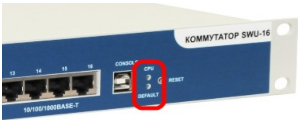
Рис.1.2. Индикаторы DEFAULT и CPU – коммутаторы SWU
