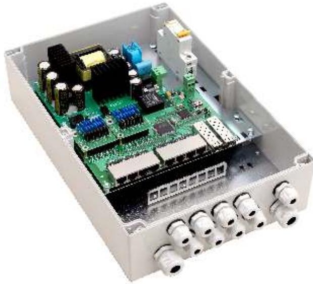
**Коммутатор TFortis PSW-2G8F+** обладает высокой эксплуатационной надежностью. Разработан для построения уличных сетей IP-видеонаблюдения с применением мощных IP-камер. Имеет 8 портов 10/100Base-Tx PoE+ с разъемом RJ-45 и 2 порта 1000Base-X с разъемом SFP. Выполнен в герметичном корпусе IP66. В состав входит оптический кросс. Рекомендован для применения при температурах окружающей среды от -55 °C до +50 °C.
