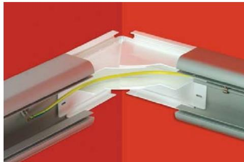
Клеммы провода заземления (код Е0001B) установите защелкиванием на направляющие, расположенные на дне оснований коробов, соединив проводом один алюминиевый кабель-канал с другим.
