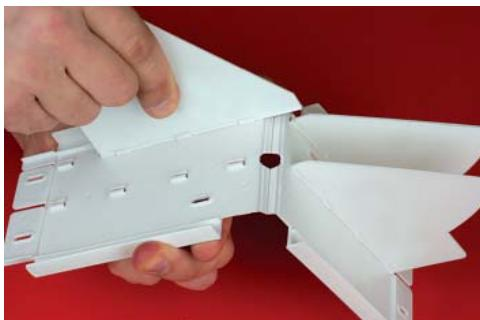
Вставьте разделятели в направляющие на базе угла. В случае, если помещение имеет угол менее 90°, рекомендуется отрезать часть разделяителя.
